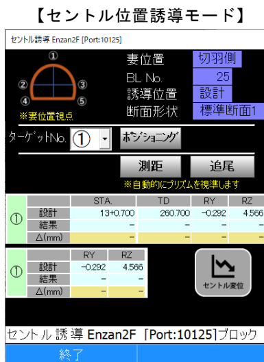
図-2 タブレット端末による各モードにおけるモニター表示(測量業務に応じ多様なモードに切り替え)
