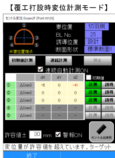
図-2 タブレット端末による各モードにおけるモニター表示(測量業務に応じ多様なモードに切り替え)
