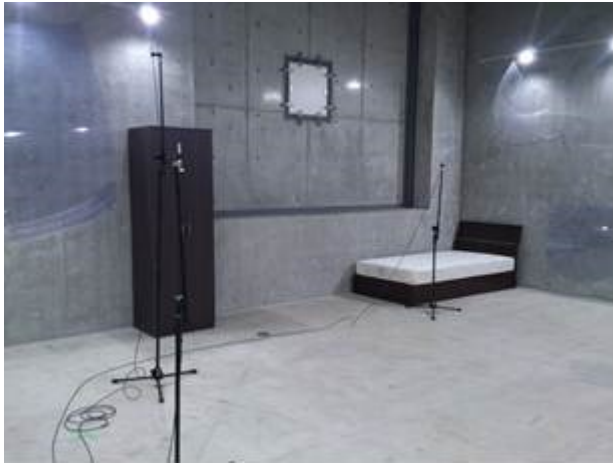
写真-1 残響室家具設置状況 (A4 残響室壁際設置)
