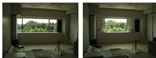
写真-1 窓開口状況 (左: 17%, 右: 8.5%)
