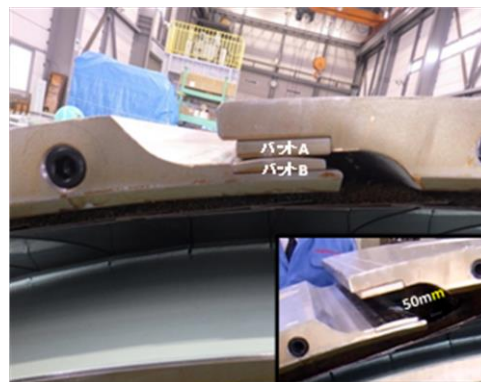
写真-3 縮径(復元)TBM 試験装置全体
