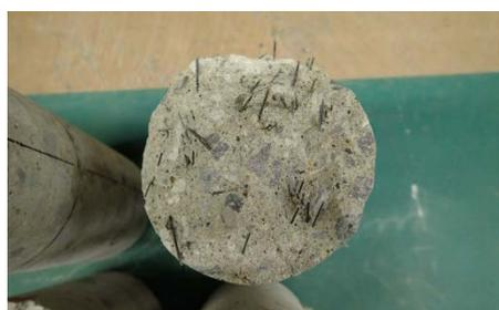
写真-6 試験後の供試体破断面
