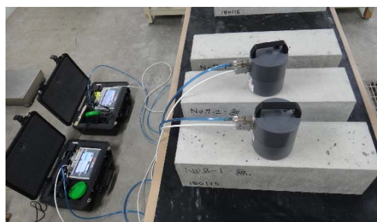
写真-3 表層透気試験 測定状況
