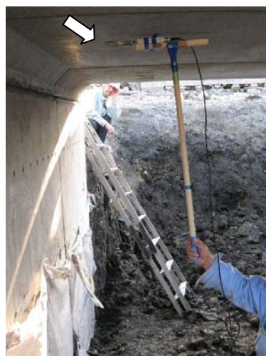
施工後のひずみ計測状況 (アンテナ(矢印)を用いてひずみ値の読取)
