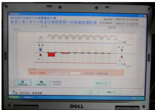
写真－3 自動計測管理
