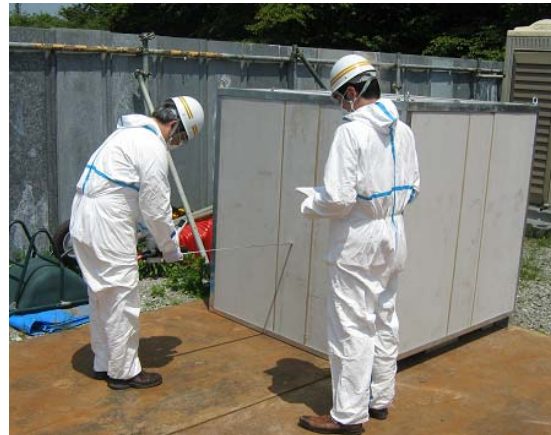
写真3 保管容器の遮蔽性能確認実験
