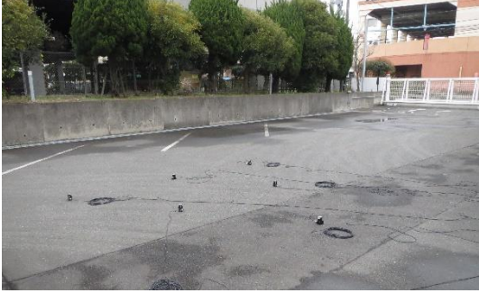
図2 常時微動アレイ探査における微動の測定状況
