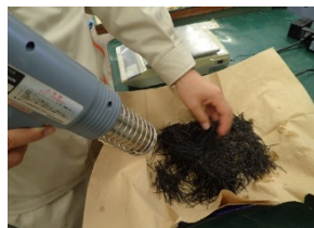
写真2 繊維混入率試験状況
