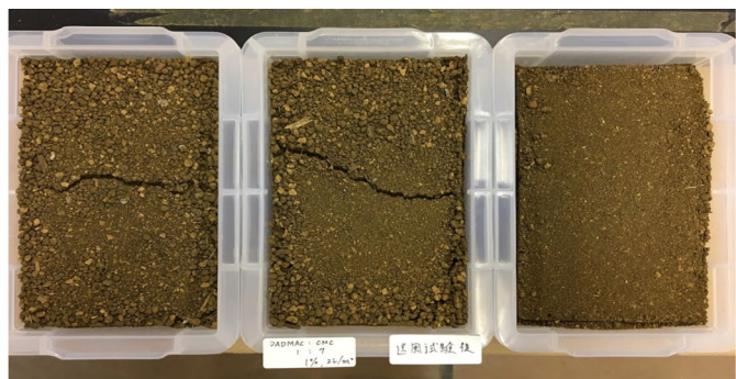
図 13 T-10(DADMAC:CMC=1:7, 散布量 2L/m 2 , 濃度 1%) の送風試験後の状況
