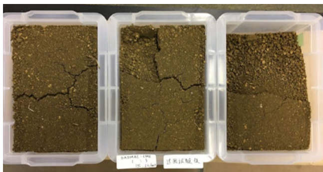
図 12 T-6(DADMAC:CMC=1:3, 散布量 2L/m 2 , 濃度 1%) の送風試験後の状況
