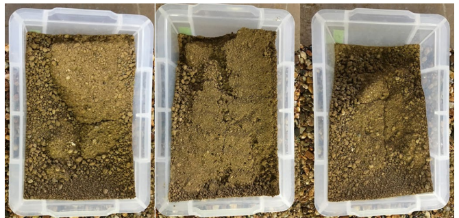
図 11 T-1(散水)の送風試験後の状況
