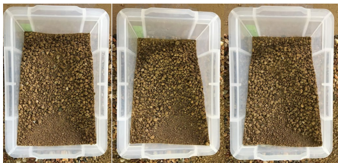
図 10 T-0(未処理)の送風試験後の状況
