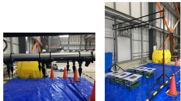
図 14 降雨試験の状況 (左) 散水ノズル(右) サンプル設置
