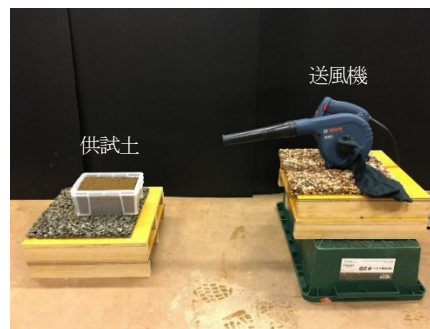
図 7 送風試験の状況
