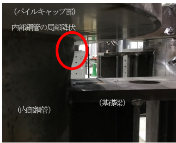
写真 4 試験体損傷状況 (No.3)
