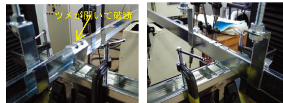
JIS-WF-N の破壊形状
