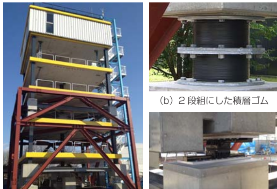
(a) 実大振動試験装置 (b) 2段組にした積層ゴム (c) 転がり支承 写真-1 実大振動試験装置の外観
