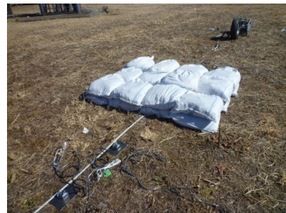
写真-1 実験状況(土のうを2段目まで積んだ状況)
