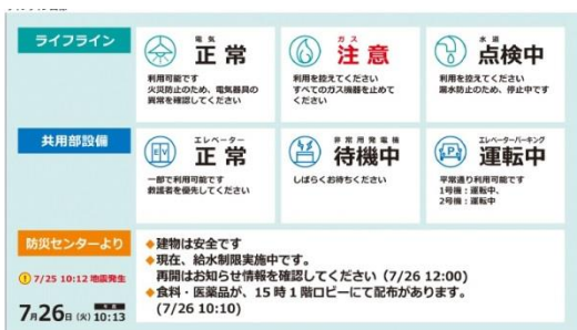
図 - 4 電子掲示板（モニター画面）における表示画面例 【収束後/被災生活期】：時間の経過に応じて、情報を提供
