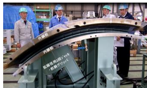
写真-4 作動試験状況 (定常時)
