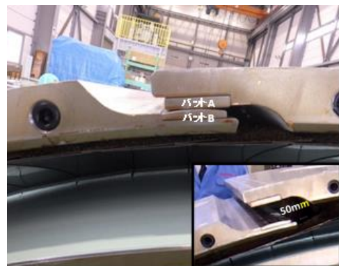
写真-3 縮径(復元)TBM 試験装置全体
