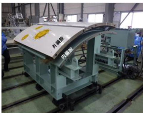
写真-2 縮径(復元)TBM 試験装置全体
