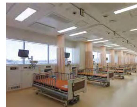
清掃のしやすさを考慮し壁掛式となっている便器。床材も壁に立ち上げることで巾木の機能を持たせ隙間を無くしている。病室では天井直付けのカーテンを採用することで、埃がたまる清潔な環境をつくりやすい。ICUにおいても天井直付けのカーテンを開仕切りとすることは、飛沫感染防止に効果的だ
