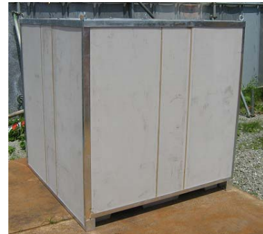
①鉄筋コンクリート製保管容器 ②バリウム含有遮蔽板を装着している状況 ③バリウム含有遮蔽板
