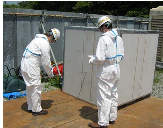
写真3 保管容器の遮蔽性能確認実験
