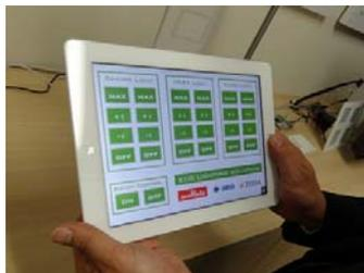
写真2 タスク&アンビエント照明の制御用タブレット端末
