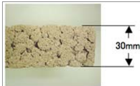
写真7 パネル断面 (厚さ 3cm)
