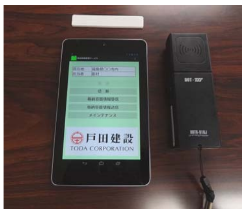
写真1 RFIDタグ (上)、タグリーダー (右)、専用アプリの画面 (中央)
