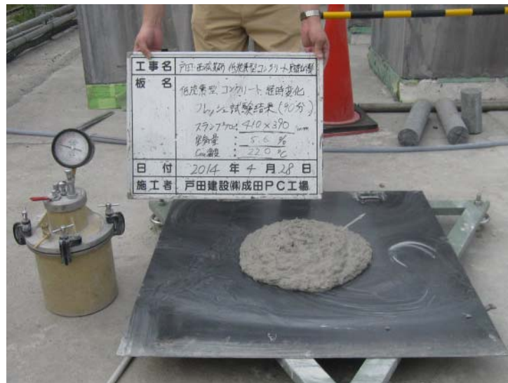
写真-3 低炭素型コンクリートの経時性状確認結果（製造から90分経過）
