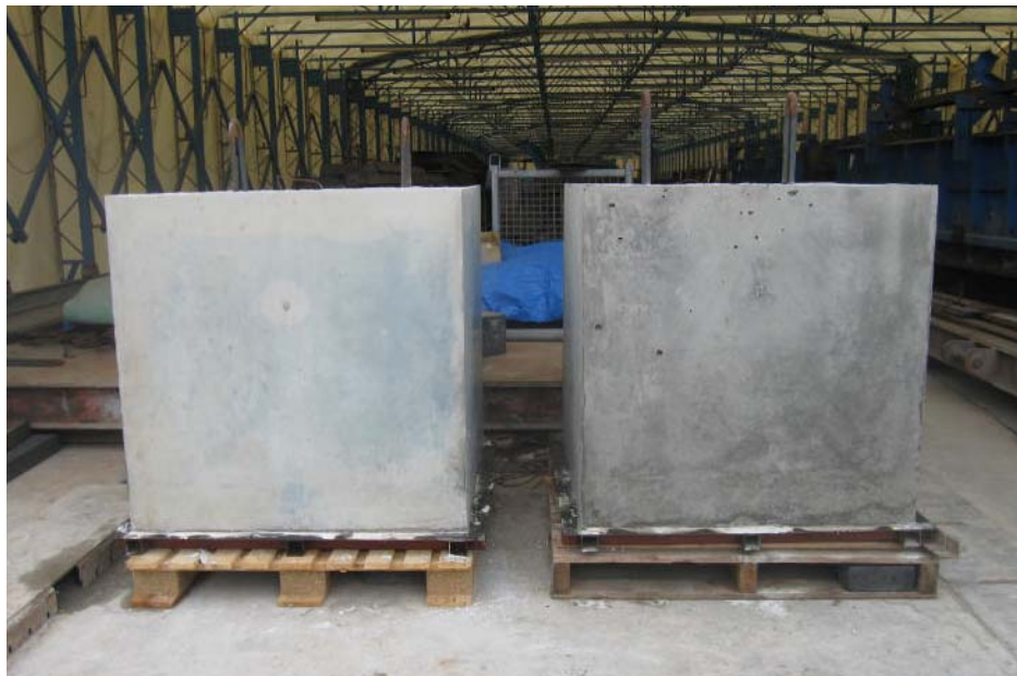
左：低炭素型コンクリート 右：普通コンクリート (27-12-20N)
