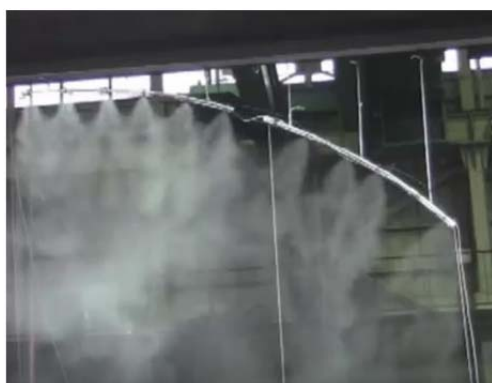
写真2 室内試験のミスト噴霧状況
