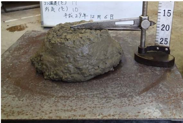
(a) 流動化前コンクリート (スランプ 18cm)
