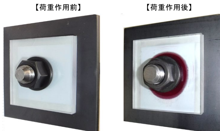
写真-1 Eye Washerを設置したロックボルト頭部(定着部)
