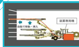
GPU 3D発破掘削 データ処理 装薬データ 発破穿孔 データ処理 ↓ AI学習 ↓ AIモデル ↓ 最適発破設計 プログラム ↓ ・薬量算出 ・穿孔位置算出
