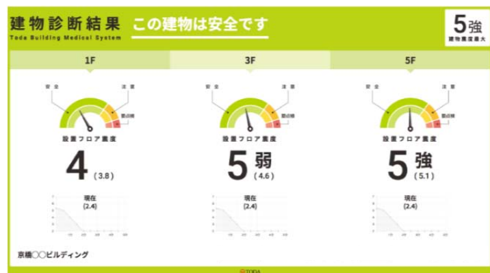
図-1 建物震度表示、建物健全性表示画面
