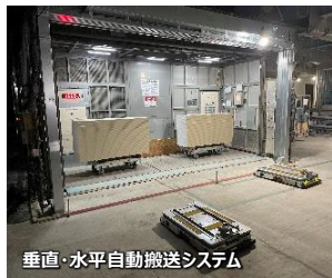
TODA BUILDINGへ 適用した自動化技術の例
