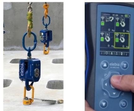
自動玉外し装置 操作リモコン
