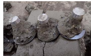
写真 8 本工法におけるプルアウト試験後の状況
