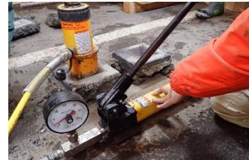
写真 7 プルアウト試験状況
