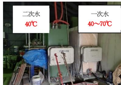
写真3 練混ぜ水加温設備
