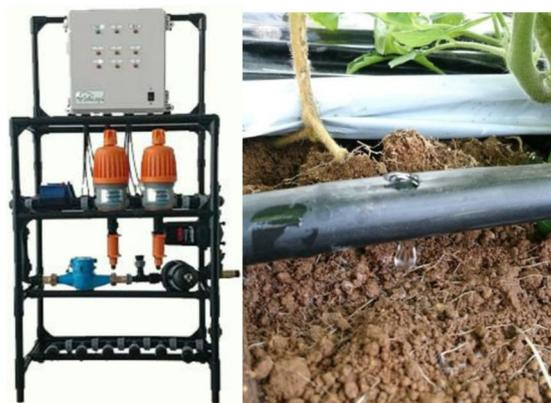
写真3 自動養液供給装置と自動灌水施肥<sup>4)</sup>
