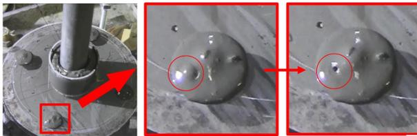
図3 バイブレーターによる気泡の動き
