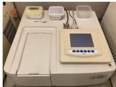
写真3 紫外可視近赤外分光光度計
