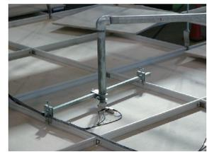
写真-7 加速度計設置状況(ボード、スプリンクラー有り)
