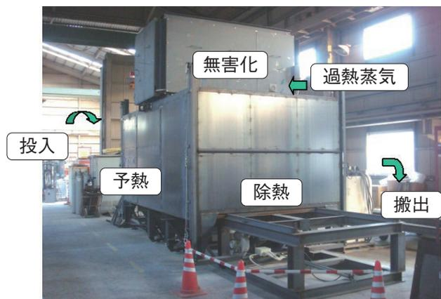
写真-3 連続加熱炉全景
