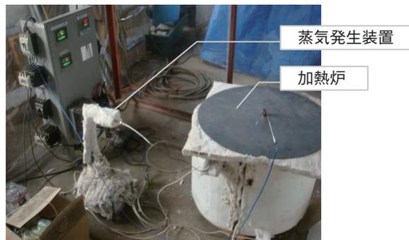
写真-2 基礎試験装置
