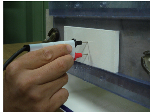
写真-2 表面抵抗の測定
