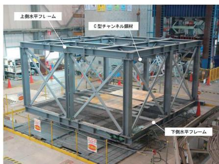
写真-1 架台フレーム
