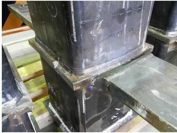
写真-2 試験体破壊状況 (試験体 1)
