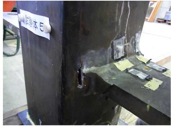
写真-3 試験体破壊状況 (試験体 5)
