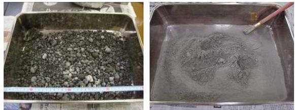
写真-3 焼成後のクリンカー(左)と完成したセメント
