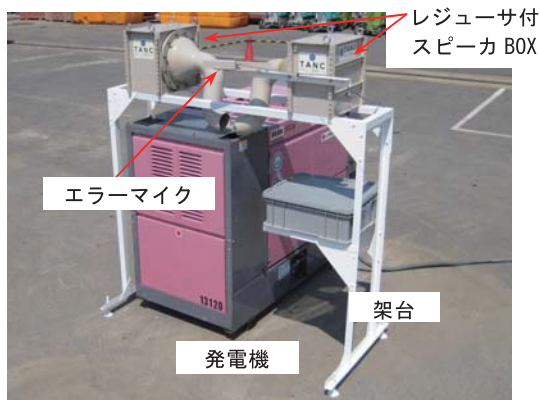
写真-2 ANCシステム設置状況
