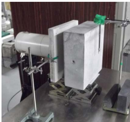
写真-7 部材の遮蔽性能実験状況 右側が線源、左の円筒がセンサ
