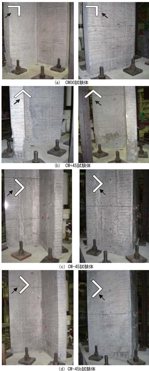
図-5 最終破壊状況
