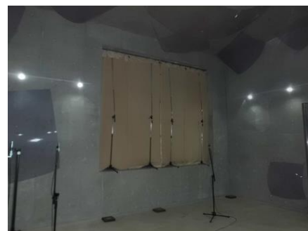
写真-4 吸音カーテン吸音率測定の様子 (音響実験棟残響室 採用カーテン)
