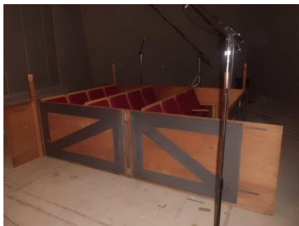
写真-3 椅子等価吸音面積測定の様子 (環境棟残響室 椅子設置ウェルあり)
