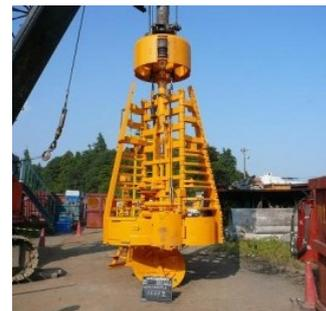
写真-1 中間拡径上部掘削機
