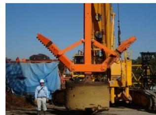
写真-2 中間拡径下部掘削機
