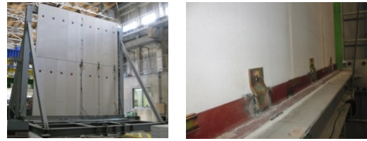
(a) 全景 (b) 中間梁と ALC パネル取付け部 写真-3 試験体
