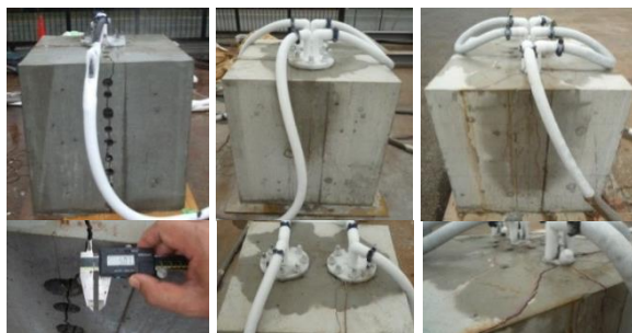
冷凍管 1 本 冷凍管 2 本 冷凍管 3 本 写真 - 2 破碎状況
