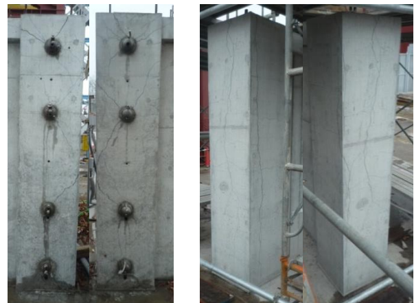
破砕管側面配置 破砕管上面配置 写真 - 3 柱破碎状況
