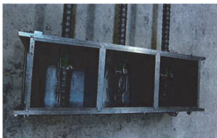
写真 - 4 ハイグリップ・メタルバンドを設置した鉄筋とコンクリートとの付着試験の試験体作成状況
