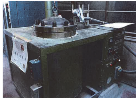
写真 - 9 オートクレーブによる腐食促進
