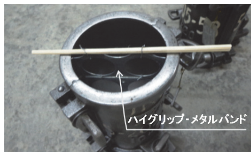
写真-2 ハイグリップ・メタルバンドを設置した試験体の作成状況
