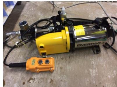
写真-2 電動式油圧ポンプ
